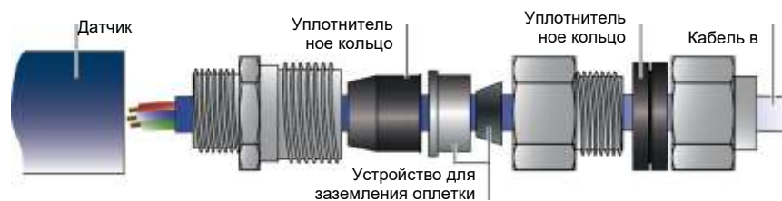
Рис. 39. Пример кабельного ввода с двумя обжимными элементами под кабель в оплетке.
