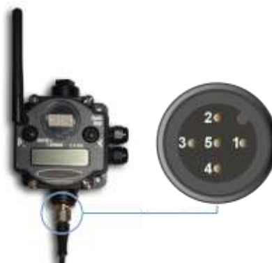
Рис. 46. Назначение выводов 5-контактного разъема Мастер-приемника .
