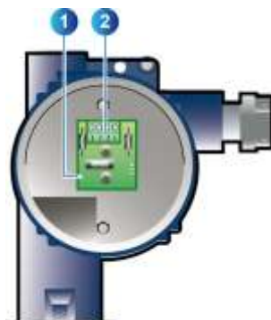
Рисунок 4: Внутренний вид газоанализатора (с удалённой платой дисплея)
