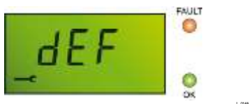
Рисунок 9: OLCT 60 в состоянии неисправности
