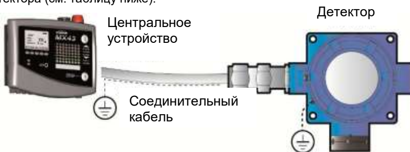
Рис 7: кабель для подключения детектора к контроллеру должен быть выбран тщательно
