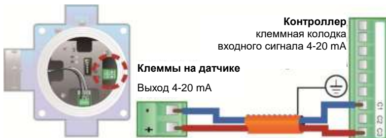
Рис 8: подключение 2-проводного детектора 4-20 мА
