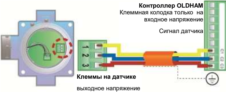
Рис 11: подключение 3-проводного детектора типа OLC 100
