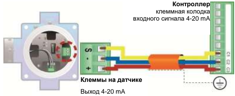
Рис 10: подключение 3-проводного детектора 4-20 мА
