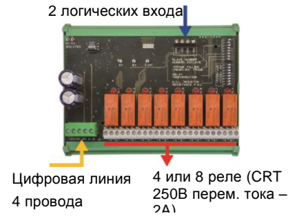
Рисунок 19: модуль на 8 реле.
